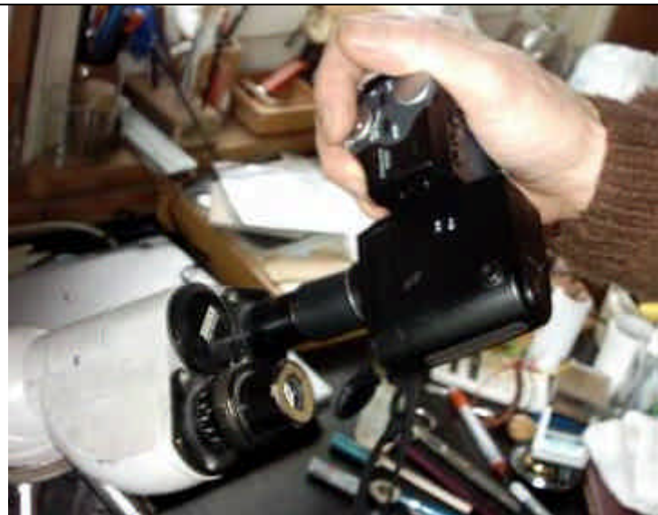
Fotografieren freihand durch ein 10x-Zeiss-Okular (im linken Tubus ein 15x-Euromex-Okular).
