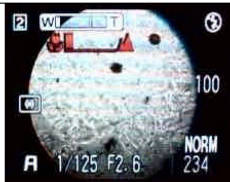
Kameraeinstellung für ringfreie Mikrofotografie: 1. Max. WW. 2. Manuell auf max. Makro (rot). 3. Zeitautomatik (A). 4. Blende 2,6. 5. Auflösung 2272 x 1704 Pixel.
